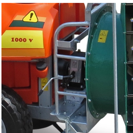
Rys. 21. Zmiana wydajności wentylatora - przełożenie przekładni wentylatora
