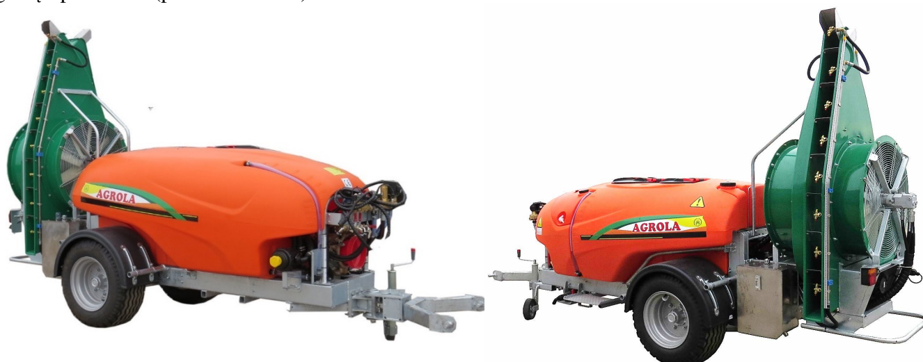
Rys. 23. Widok opryskiwacza dwuwentylatorowego z asymetryczną regulacją strumienia powietrza
